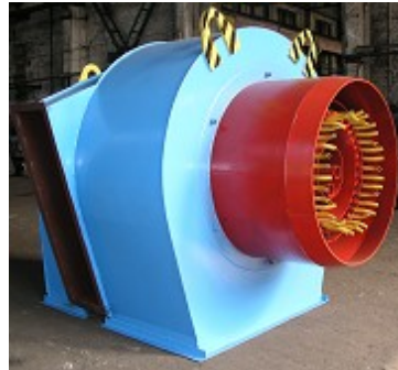
Газомазутная горелка котла Е-75 ОАО «ЗАЛК», г.Запорожье
