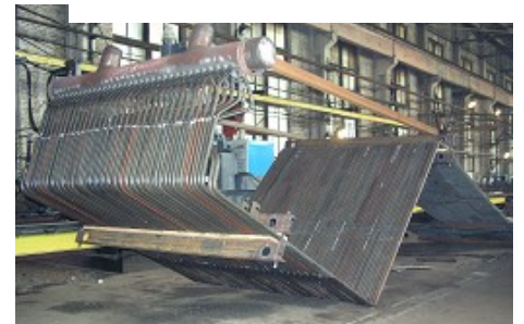
Панель НРЧ блока 800 МВт Славянской ТЭС
