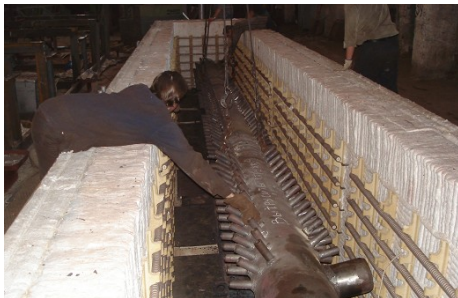
Печь электрическая для термообработки (11000 × 1200 × 1500 мм)
