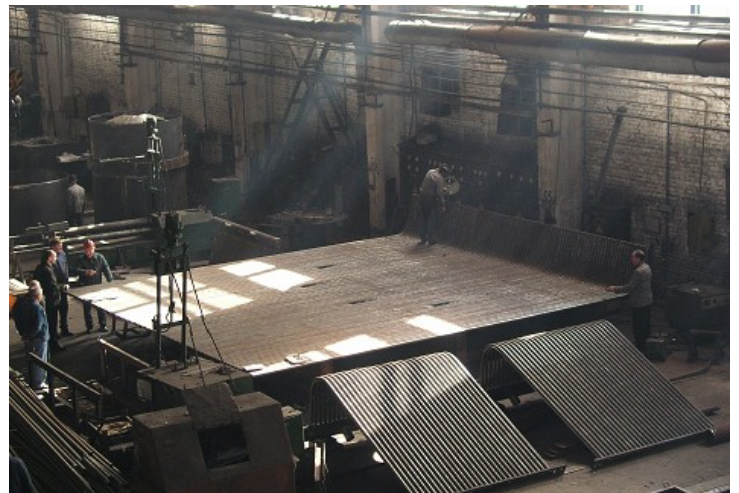
Контрольная сборка фронтного экрана котла Е-100-3,9-440ГМ
