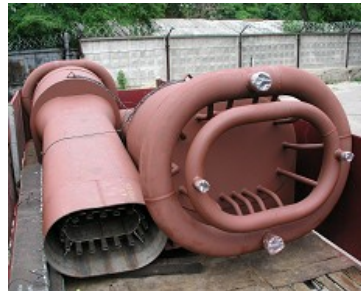
Многотопливная горелка котла Е-120/150-3,2-390 ДКГМ ТЭЦ ОАО «Запоржсталь», г. Запорожье
