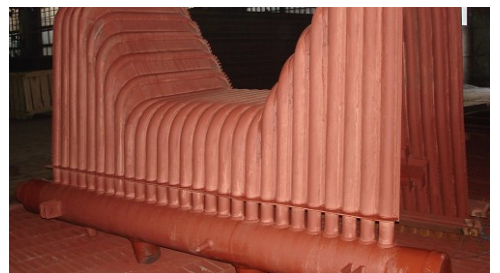
Коллектор (Ø377×70) конвективного пароперегревателя высокого давления котла ТПП-312А Запорожской ТЭС
