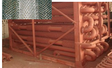
Коллектор (Ø377×70) конвективного пароперегревателя высокого давления котла ТПП-312А Запорожской ТЭС
